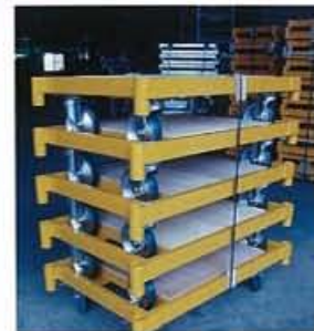
事例6: 台車 (段積状態)
