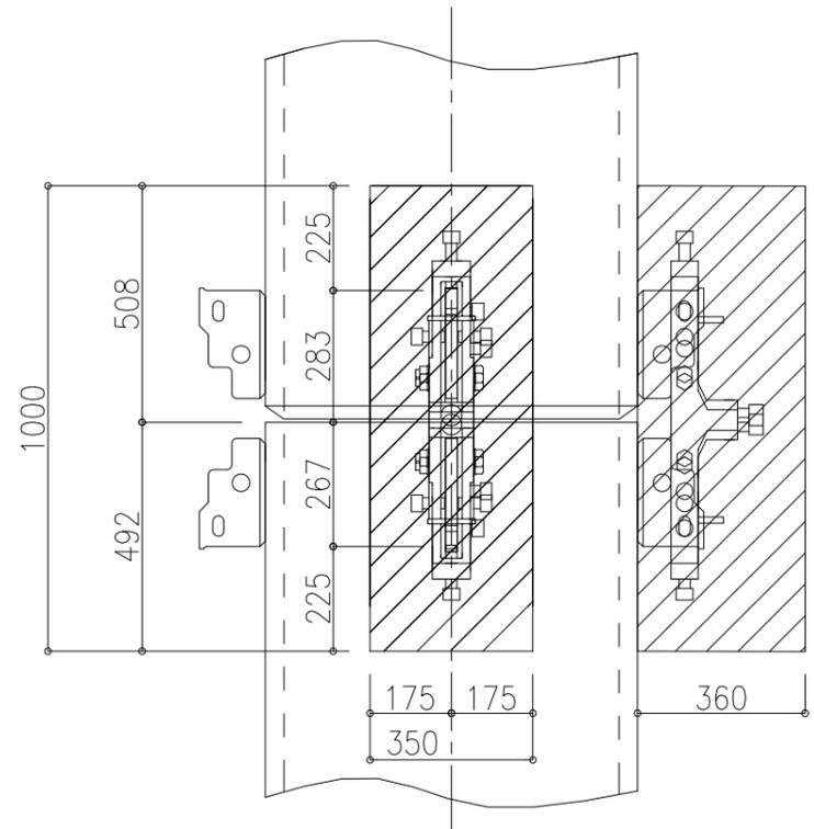
ATOMU-802の操作に必要なクリアランス (待ち受けタイプ、吊り下げタイプ)
