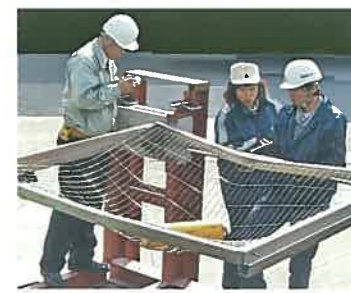
マンション用落下防止ネットの強度試験
