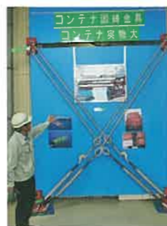
コンテナラッシング金物。荷崩れを防ぐ重要な部品だ
